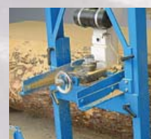
Cabezal tensor y regulación de altura
