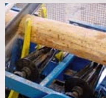
Tracción en ambos sentidos mediante rodillos cónicos
